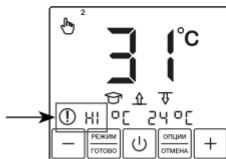
Рис. 18. Замыкание датчика обогрева
