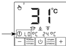
Рис. 17. Обрыв датчика обогрева
