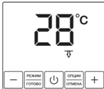
Рис. 12. Установка максимальной температуры воздуха
