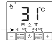
Рис. 16 б. Высокая температура
